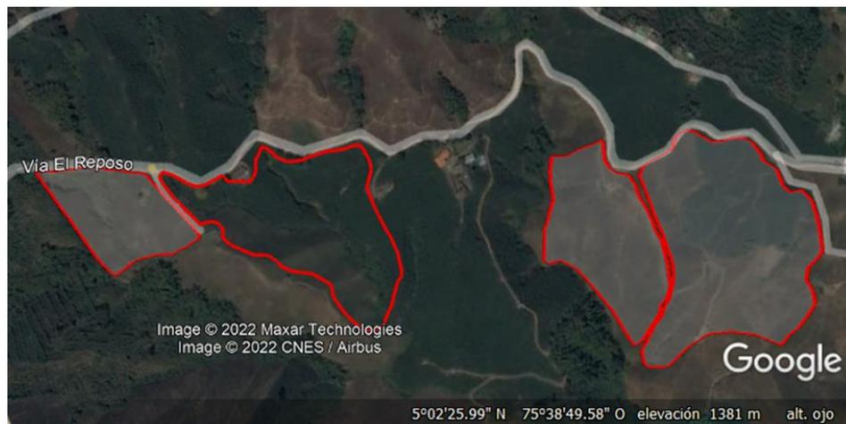
**Zona de depósito Corozal:** Con respecto a esta zona de depósito se tiene actualmente una alternativa de conformación del ZODME realizada por SEDIC S.A la cual contempla una capacidad aproximada de 532.009 m<sup>3</sup>.
