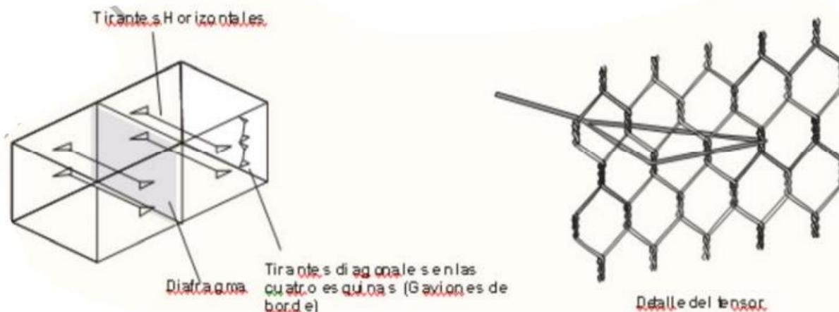
Figura 681 –3. Disposición de tirantes o tensores
