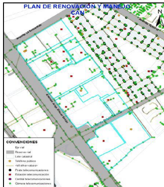
Ilustración No. 8 – Redes existentes de Telecomunicaciones en el sector del CAN.
