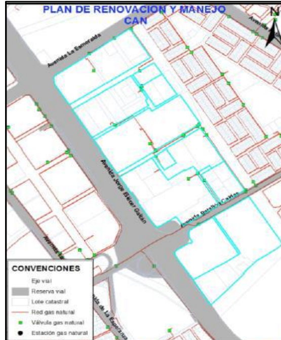
Ilustración No. 7 – Redes existentes de Gas domiciliario en el sector del CAN.
